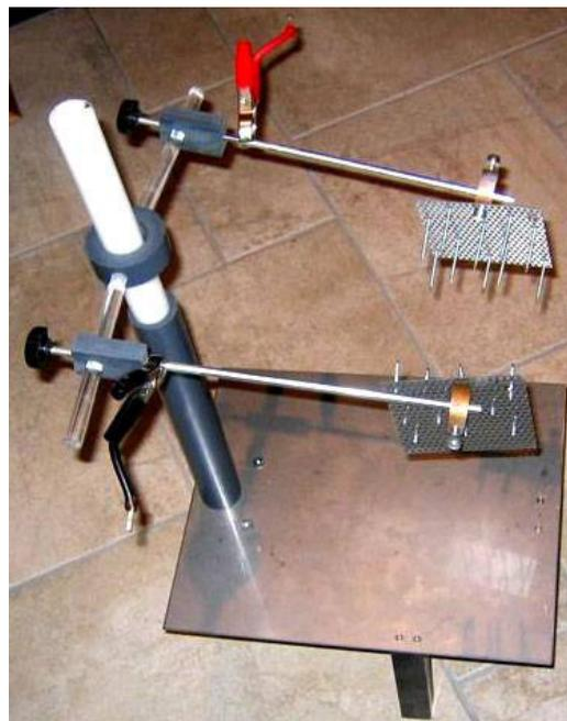
Рисунок 3 – Действующая макетная установка Дудышева электрического пожаротушения
